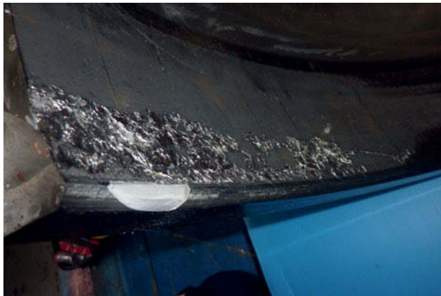
Bild 1: Schaden am Hauptlager an einer 600 kW WEA, Foto: Martin Veltrup
