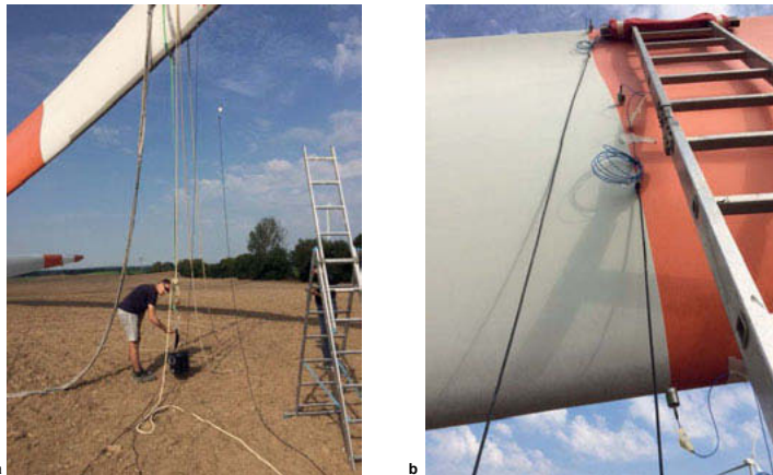
Bild 3: Klassische Modalanalyse am Rotorblatt a Lastpfad der Anregung b Beschleunigungsaufnehmer 2, 5 und 7
