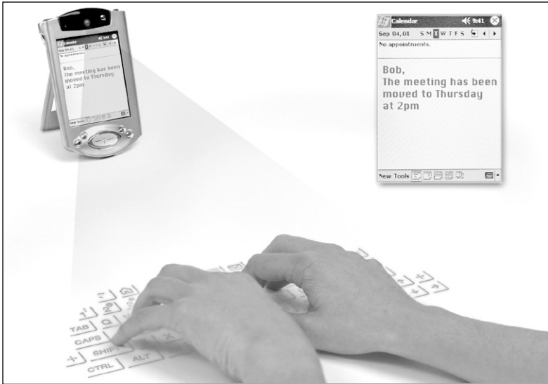
Abbildung 2: Durch Licht projizierte Tastatur (Reproduktion mit Genehmigung der Firma Canesta, Inc.).
