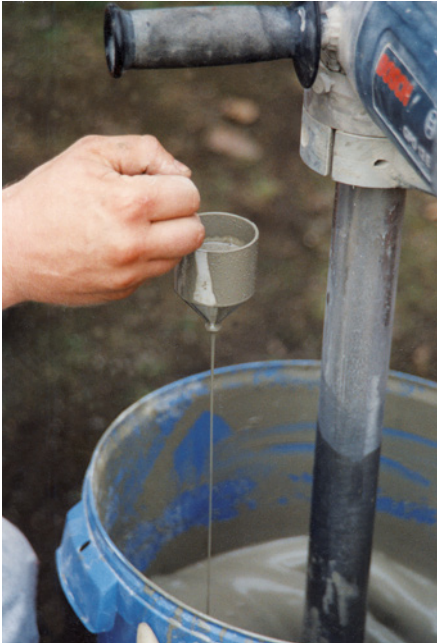
Bild 171: Überprüfung der Konsistenz des Injektionsmittels
