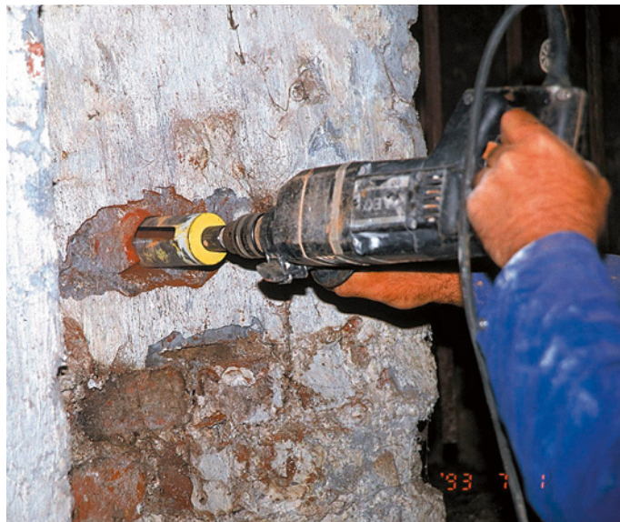
Bild 13: Entnahme von Bohrkernen für die Bauzustandsanalyse an einem Sand- steinmauerwerk
