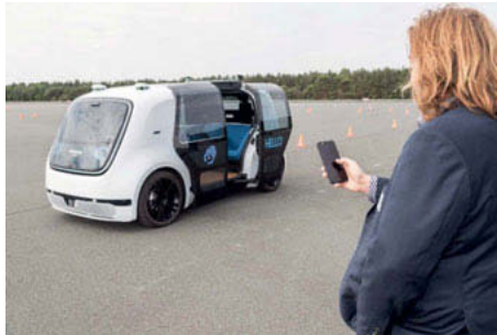
Bild 8: Bei Ankunft des SEDRICs am Abholort erfolgt eine automatische Begrüßung auf den Außendisplays sowie eine automatische Türöffnung via Bluetooth-Verbindung zwischen Fahrzeug und SEDRIC App
