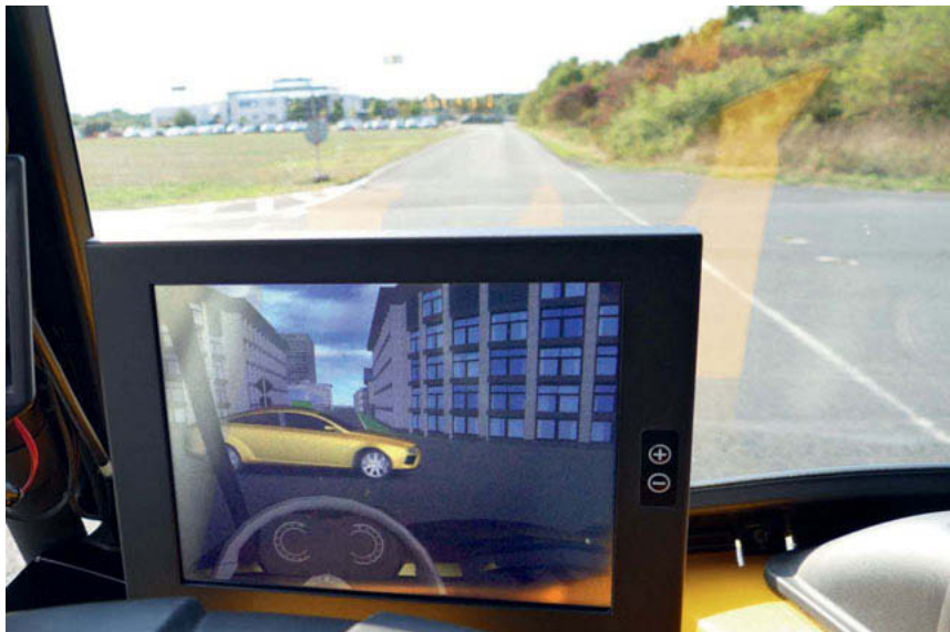
Bild 2: Vehicle-in-the-Loop: Betrieb eines realen Fahrzeugs in einer virtuellen Verkehrssituation am Beispiel eines Kreuzungsassistenzsystems
