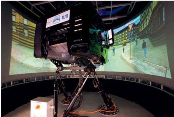
Bild 2: Dynamischer Lkw-Fahrsimulator des Lehrstuhls für Fahrzeugtechnik
