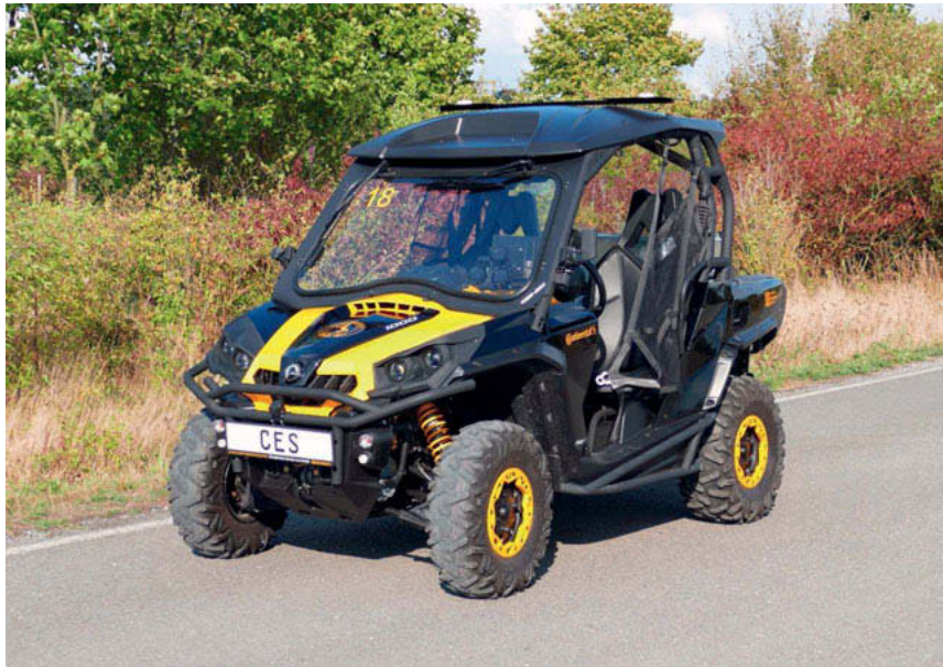
Bild 1: Lab-on-Wheels Demonstrator auf Basis eines CanAm Commander Side-by-Side
