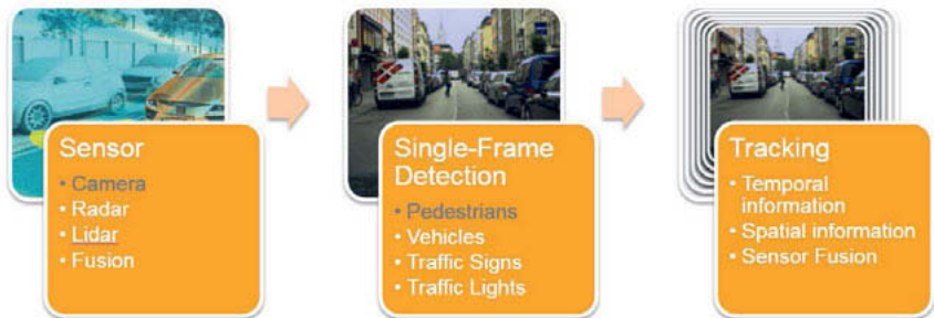
Bild 4: Aufbau einer sensorbasierten Fußgängererkennung für Fahrerassistenzsysteme und automatisiertes Fahren, mit Fokus auf der Erkennung von Fussgängern in Einzelbildern.
