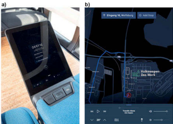
Bild 4: (a) Mittelkonsolendisplay mit dem Drei-Knopf-Modul und (b) Inhalte vom Mittelkonsolendisplay zur Interaktion des Nutzers mit dem Fahrzeug während der autonomen Fahrt
