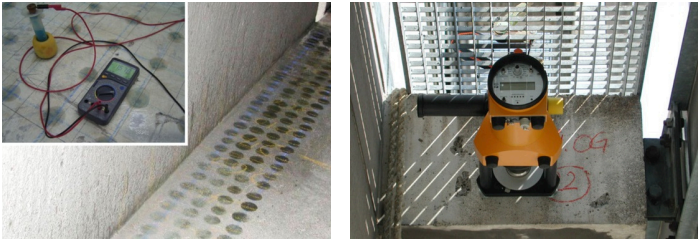
Bild 4-5: Potentialdifferenzmessung (links) [I.15], Haftzugprüfung (rechts) [I.18]
