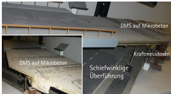
Bild 3-19: Kleinmaßstäbliches Modell einer schiefwinkligen Brücke aus Mikrobeton
