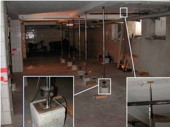
Bild 4-6: Messeinrichtung für den Belastungsversuch einer Hofkellerdecke [I. 14]
