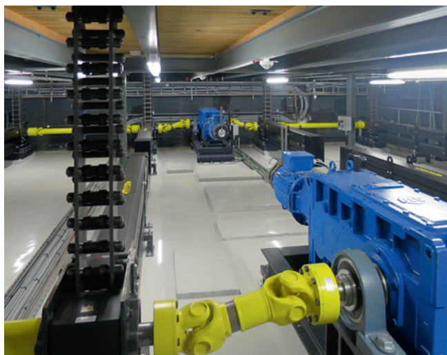
Abb. 21: Die Schubkettenantriebe schieben das Bühnenpodium in Position. Ein erheblicher Teil der Baukosten wurde in solche technische Ausstattung investiert. (© Brenne Architekten)
