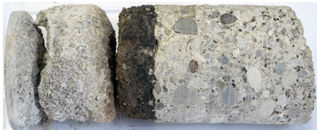
Abb. 5: Bohrkern eines Fußbodenaufbaus: Als Dämmmaterial zwischen Bodenplatte und Estrich wurde Teerkork eingebaut.
