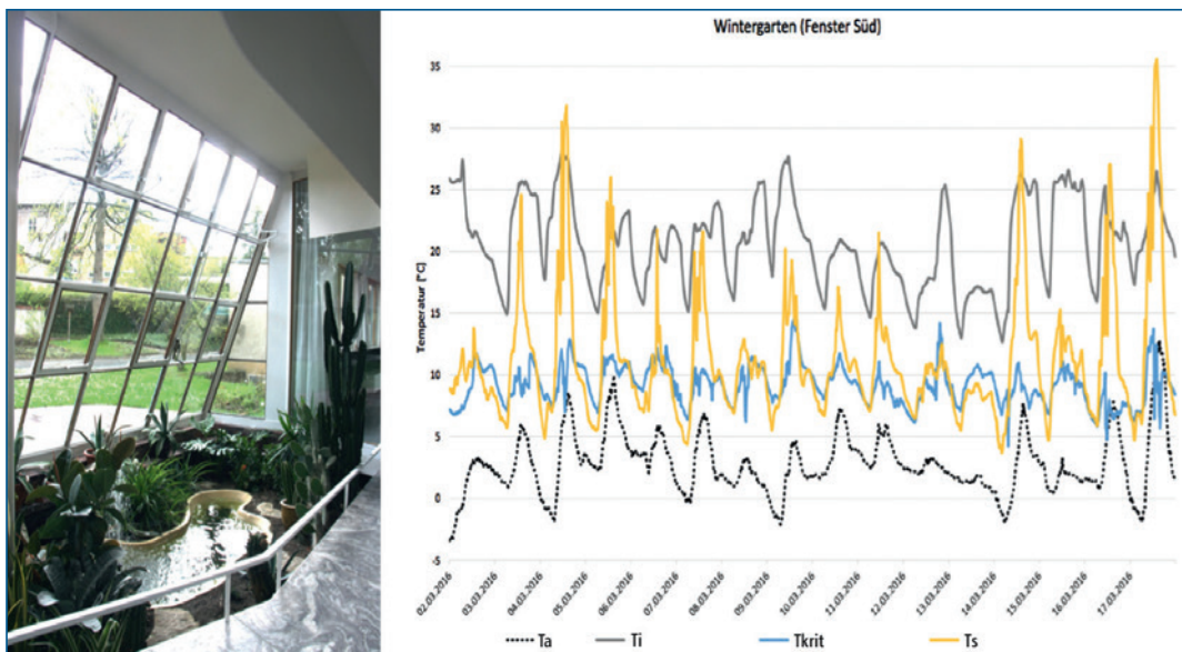
Abb. 6: links: Innenansicht der Südfassade im Wintergarten Haus Schminke, rechts: Messwerte aus dem März 2016 Legende: Ta: Außenlufttemperatur, Ti: Raumlufttemperatur, Tkrit: kritische Oberflächen- temperatur mit 80 % rel. Luftfeuchte, Ts: Oberflächentemperatur
