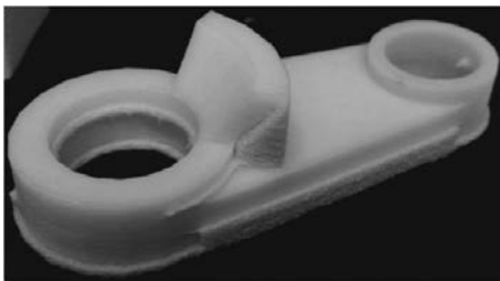
Bild 9: Additiv gefertigtes Bauteil mit wasserlöslicher Stützstruktur
