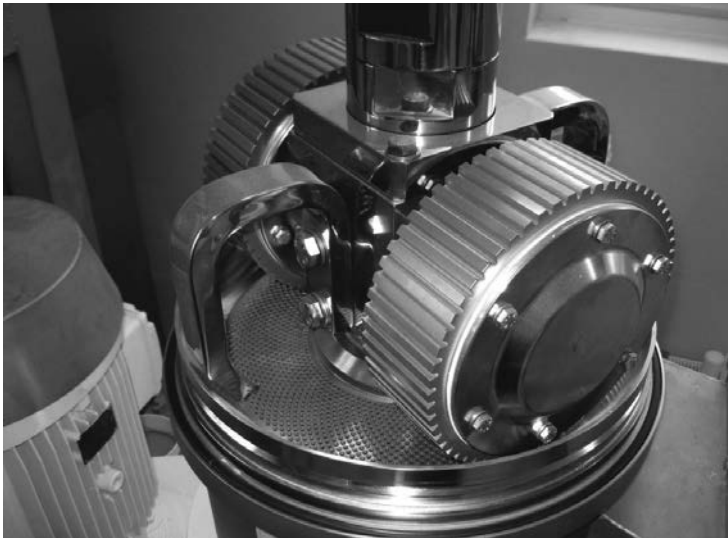
Bild 2: Kollerkopf mit Kollern, Matrice, Räumern einer Flachmatrizenpresse
