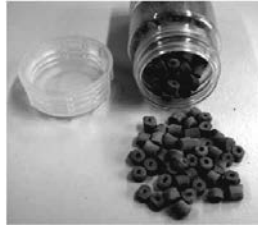
Bild 8: Katalysatorträger als Schüttgut für Kraftwerke und in Honigwabenstruktur für Autoabgaskatalysatoren
