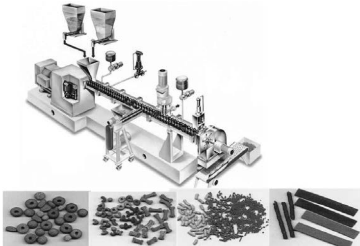
Bild 13 : Anlagenbeispiel für die Kochextrusion von trockenem Heimtier- und Fischfutter
