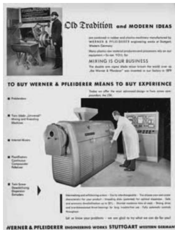
Bild 2: Ablösung des 1879 erfundenen Chargenkneters durch den ersten produzierenden ZSK83 im Jahr 1957 [2]
