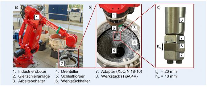
Robotergeführtes Fliehkraftgleitschleifen; a) Übersicht der Versuchsumgebung; b) Fliehkraftgleitschleifanlage; c) Werkstück. Grafik: IWF
