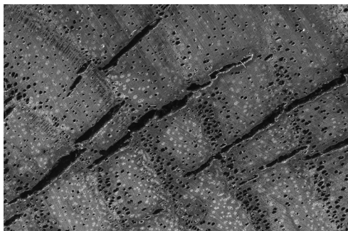
❹ CeramicWood Mikroaufnahme. Institut für Materialdesign IMD an der HfG Offenbach, gemeinsam mit Werner Lorke
