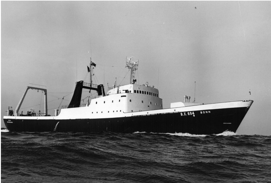
Abb. 1: Heckfänger FMS BONN, gebaut 1964 bei der Seebeck-Werft in Bremerhaven und 1974/75 für das MEXAL-Projekt eingesetzt. (Foto: Archiv des Deutschen Schifffahrtsmuseums)
