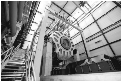
Bild 1: Gondelprüfstand des Dynamic Nacelle Testing Laboratory ("DyNaLab")
