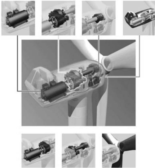
Bild 3: Sowohl einzelne Triebstrangkomponenten als auch Triebstranggruppen erzeugen bei Abweichungen vom bestimmungsgemäßen Zustand Zusatzschwingungen
