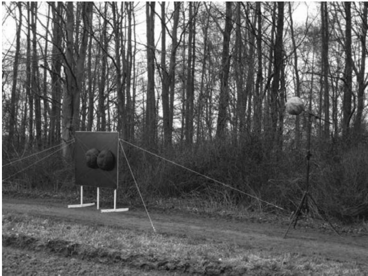
Bild 14: Messaufbau einer Immissionsmessung mit Messplatte und Stativ vor einer Baumreihe
