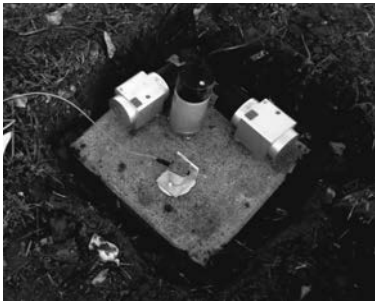
Bild 8.2: Messpunkt mit einem vertikalen und zwei horizontalen Seismometern (Geospace Corp. HS-10) sowie einem vertikal orientierten Geophon (SENSOR Nederland b.v. SM6) für eine Referenzmessung
