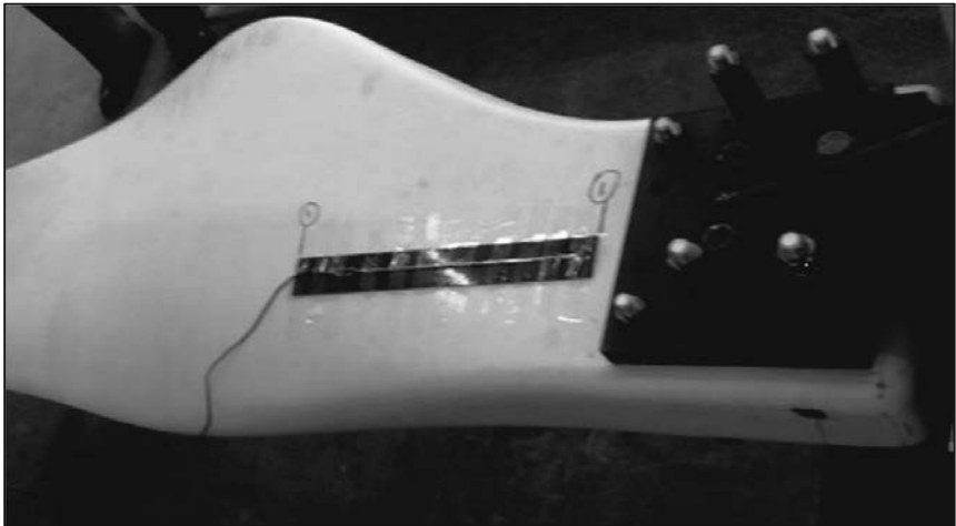
Bild 7: Sensorfaser (auf Carbonträger) auf dem Rotorblatt angebracht (Position 1).
