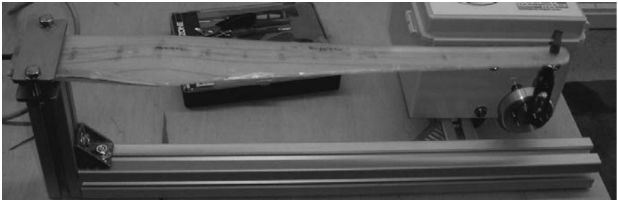
Bild 3: Prüfstand für Labormuster (links: Blattwurzel, rechts: Anregung mit Motor).
