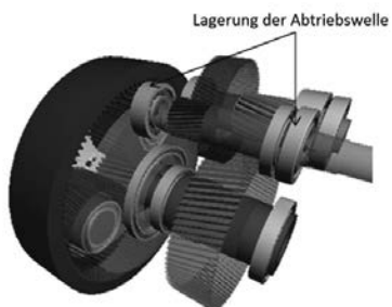
Bild 2: Getriebeschema mit einer Planeten- und zwei Stirnradstufen
