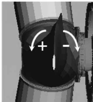
Bild 6: Definition der Winkelangabe des Einbauwinkels in der Simulation
