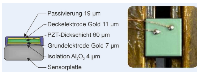
Bild 2. Schichtaufbau (links) und realer Sensor (rechts). Grafik: Fraunhofer IWU
