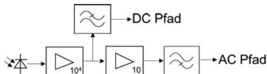
Abbildung 6.10.: Blockschaltbild des Transimpedanzverstärkers HCA-S.
