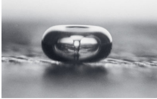
Abbildung 2.6.: Asymmetrische Implosion einer Kavitationsblase in der Nähe einer Oberfläche. [LSW09]
