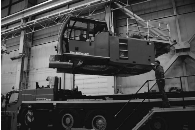
Bild 6: Servicefall Kategorie-A: Streckgrenzengesteuertes Anziehen bei Firma Liebherr
