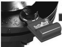
Beispiel: Direkte Messung der Montagevorspannkraft mittels einer Messunterlegscheibe
