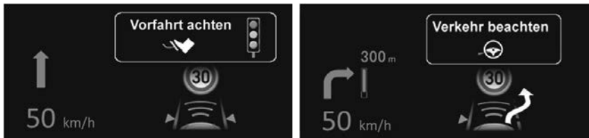
Bild 1: Beispielhafte grafische Ausgaben des Urban Assist im Head-Up Display (HUD).
