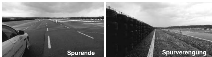
Bild 4: Baustellenszenarien auf der Teststrecke: Spurende und Spurverengung
