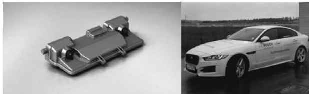
Bild 2: Stereovideo Kamera Generation 2 und Versuchsfahrzeug
