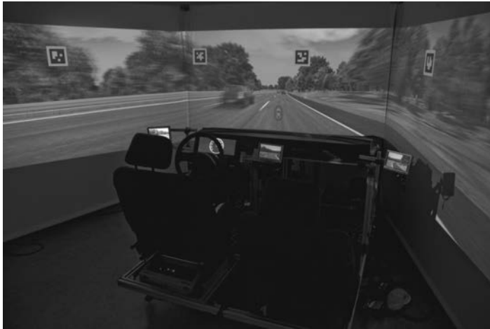
Bild 1: Konfiguration der Sitzkiste und des Simulator-Raums
