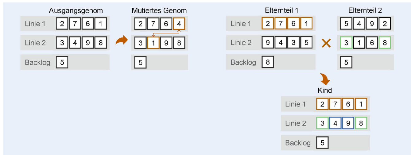
Bild 3. Links: Mutation eines Genoms durch zufälligen Tausch zweier Produkte im Plan. Rechts: Crossover Operation. Orange markierte Produkte wurden von E1 kopiert, grüne aus E2. Blau markierte Produkte mussten neu gesetzt werden. Grafik: FH Bielefeld
