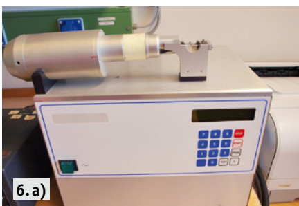
Bild 4: Prüfung der Nadelpenetration nach DIN EN 1426
