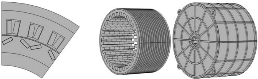
Bild 2: Links: Elektromagnetisches Teilmodell; rechts: Strukturdynamisches Teilmodell (Stator, Kühlmantel ohne, bzw. mit Maschinengehäuse)
