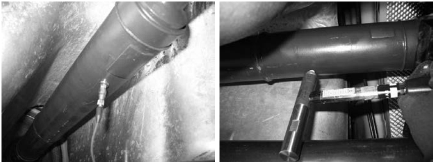
Bild 2: Anbindung des Beschleunigungssensors und Erregung mit Modalhammer
