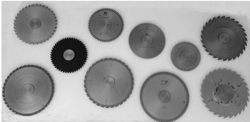
Bild 1: Scheibenförmige Werkzeuge für unterschiedlichste Trennprozesse, hier Kreissägewerkzeuge für die Holzbearbeitung
