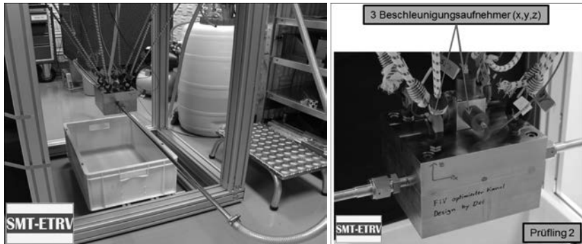
Bild 2: Links: Messaufbau mit in weichen Gummiseilen frei-frei aufgehängtem Prüfling (inkl. lange Adapterrohre). Im Hintergrund ist das Fluidreservoir zu sehen; ein weiteres Reservoir steht in der Etage oberhalb des Labors, das den statischen Vordruck aufbaut; der Sollfluss wird durch ein Ventil eingestellt und mittels Durchflussmesser überwacht. Rechts: Möglichst schwerpunktnahe Anbringung der in Triax-Konfiguration aufgebauten hochempfindlichen Beschleunigungssensoren am Prüfling.
