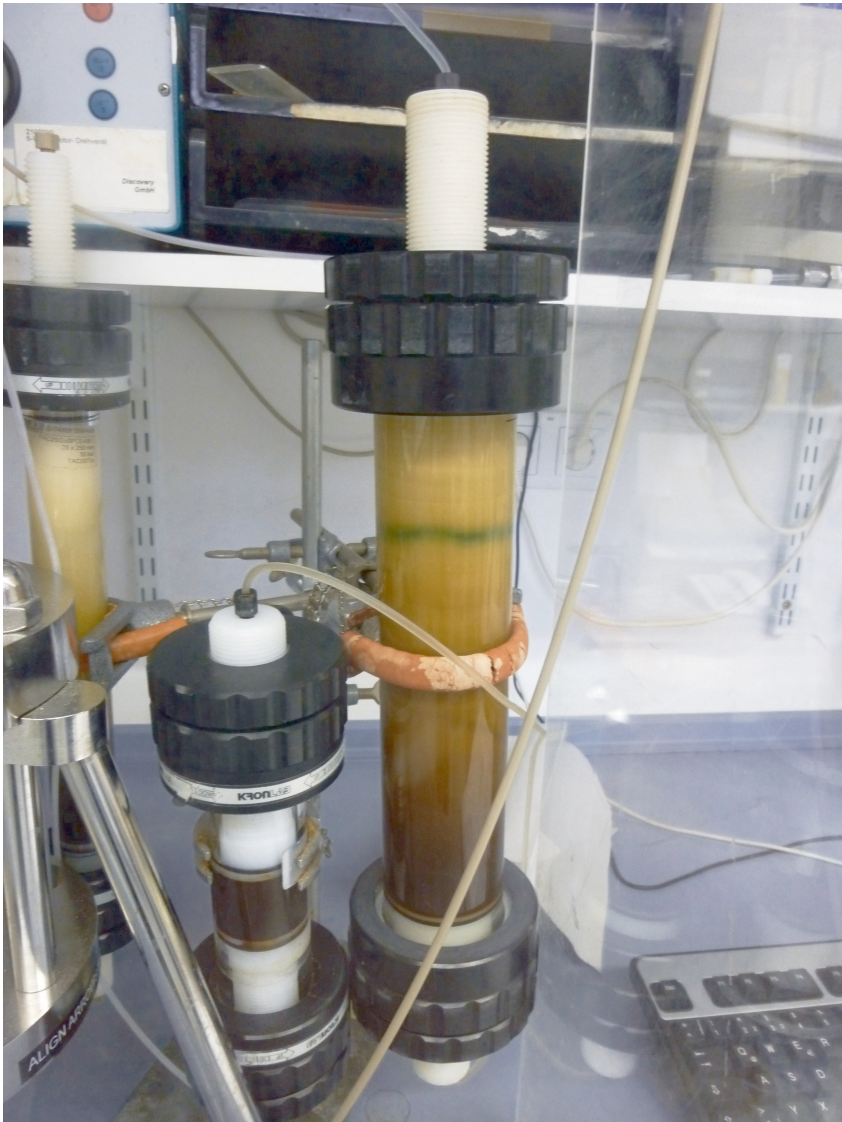
Abbildung 2: Säule für chromatografische Trennungen (Vortrennung); 24.11.2011
