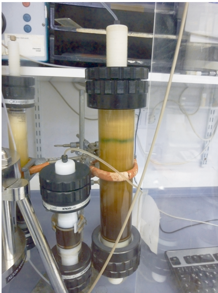
Abbildung 2: Säule für chromatografische Trennungen (Vortrennung); 24.11.2011
