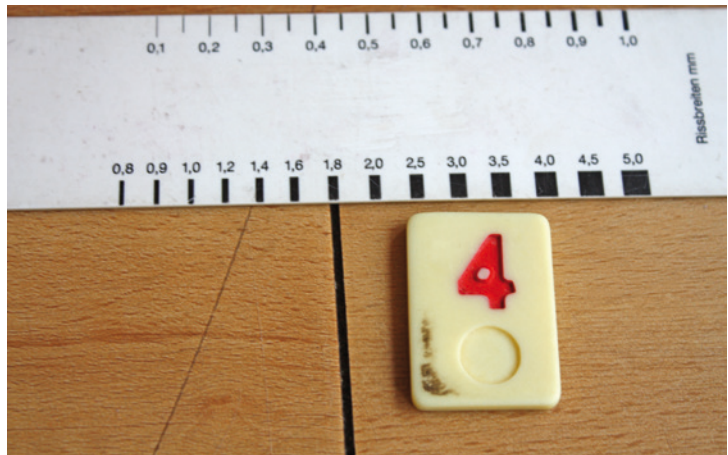
Abb. 51: Fugenbreiten von 1,8 mm in PVC-Design-Planken wird kein Bauherr hinnehmen
