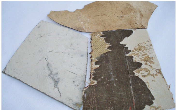
Abb. 39: Beispiele für abgeplatzte Spachtelmassen aufgrund nicht fachgerechter Untergrundvorbereitung
