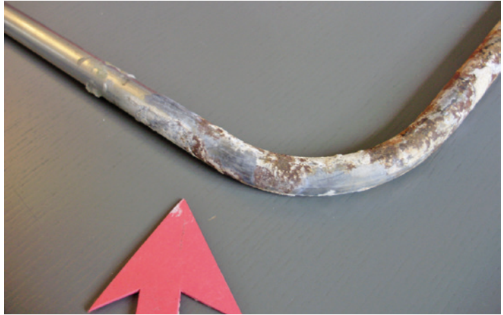
Abb. 27: Korrodiertes Heizungsrohr besonders im gebogenen Bereich
