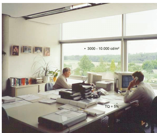
Abbildung 5: Seitenfenster ohne Blend- und Sonnenschutz mit den auftretenden Leuchtdichtevertellungen.
