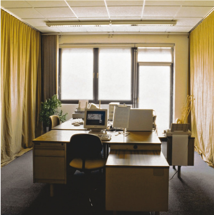
Abbildung 13: Textiles Blendschutzrollo, welches die Leuchtdichte des Außenraumes auf die geforderten 200 bis 300 cd/m 2 reduziert. Es verhindert jedoch die Sicht nach Außen und reduziert das einfallende Licht auf ca. ein 1/10 des Außenraumes, wodurch das Helligkeitsniveau im Inneren zu niedrig ist.
