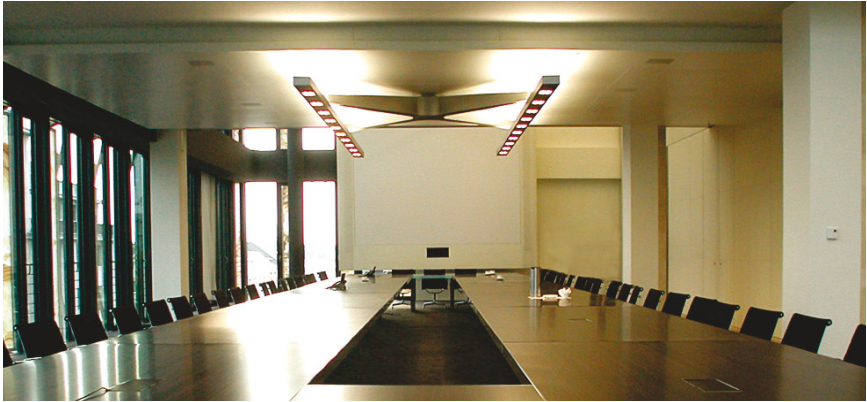
Grafik: Konferenzraum mit DSP gesteuerten Schallzeilen, eingebaut in die Leinwand
