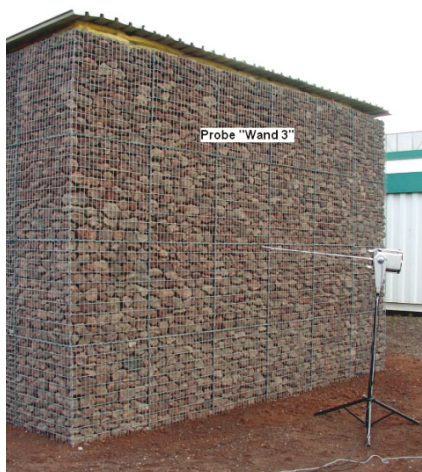
Abbildung 4: Abbildung aus dem Jahr 1939 aus 2007 zur Bestimmung des Absorptionsgrads einer Oberfläche im Freien.
