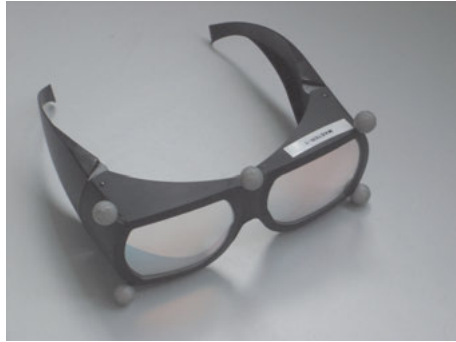
Abbildung 5: Infitec-Filterbrille mit reflektierenden Kugeln als Trackingziele
