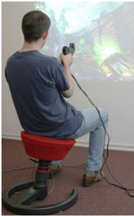
Abbildung 1: Das ChairIO als Spiele Device mit einem zusätzlichen Handeingabegerät. Rechts sind die Bewegungs- und damit Steuermöglichkeiten des ChairIO's dargestellt. Hier wird der Swopper™ from aeris-Impulsmöbel GmbH als Basisstuhl des ChairIO eingesetzt.
