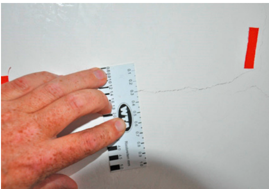
Bild 16 Detailaufnahme einer Rissbreitenmessung mit Rissbreitenvergleichtsmaßstab
