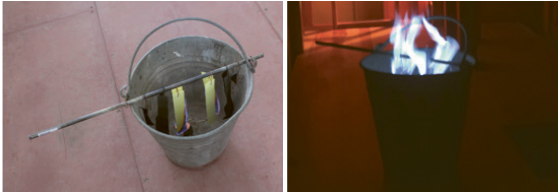
Abb. 82 Schwefel-Versuch: in einem Blecheimer werden Schwefelschnitten abgebrannt
