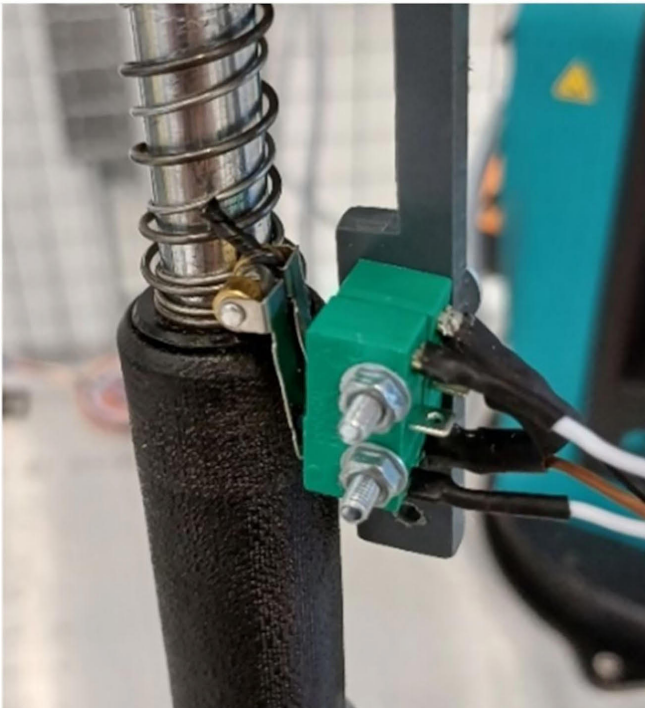
Bild 5. a) Pin-Erkennung über Taster an der Welle des Schraubers; b) durch Messung des Federwegs mittels Lasersensor. Foto: Fraunhofer IPA
