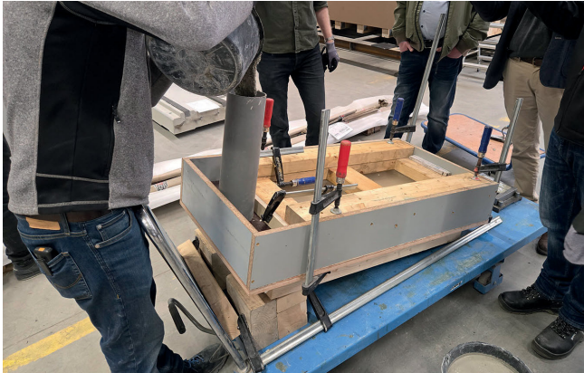
Bild 8. Gießversuch in bewehrter, geschlossener, geneigter Schalungsbox mit Plexiglasscheibe, um die ausreichende Fließfähigkeit zu überprüfen Foto: durcrete GmbH Fig. 8. Pouring Test in Closed Formwork with PMMA Backside to Demonstrate Sufficient Flowability Source: durcrete GmbH
