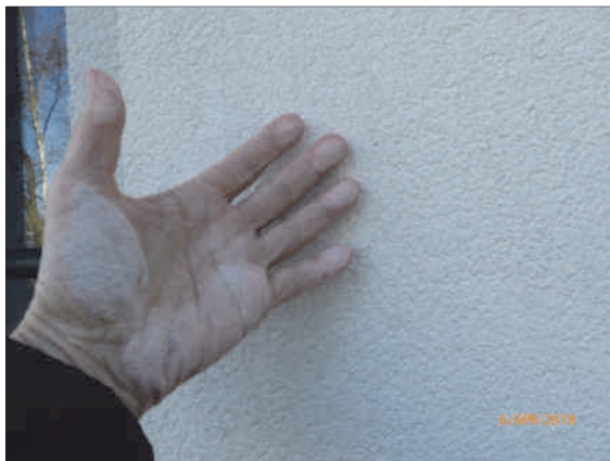
Abb. 2: Abreiben mit der Hand – Anstrich kreidet deutlich
