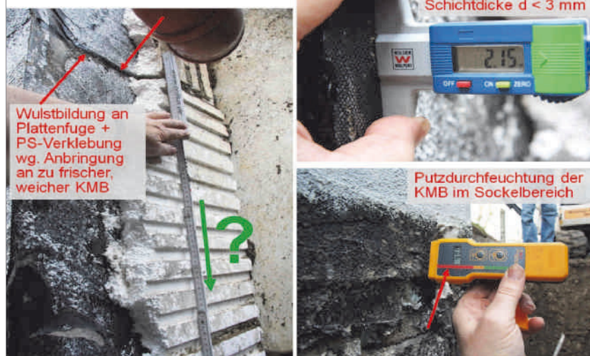
Abb. 2: Fehler an KMB-Abdichtungen
