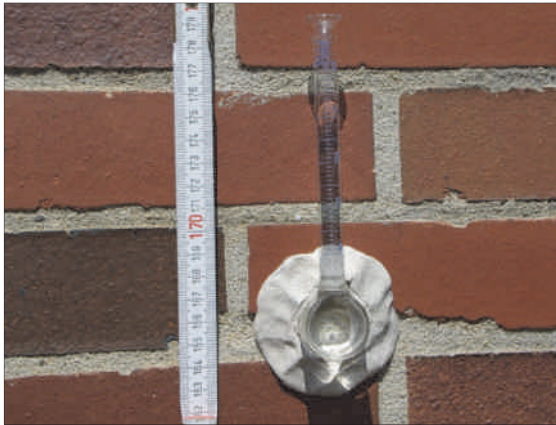
Abb. 4: Überprüfung des vorhandenen Schlagregenschutzes, zum Beispiel mit Prüfröhrchen nach Karsten
