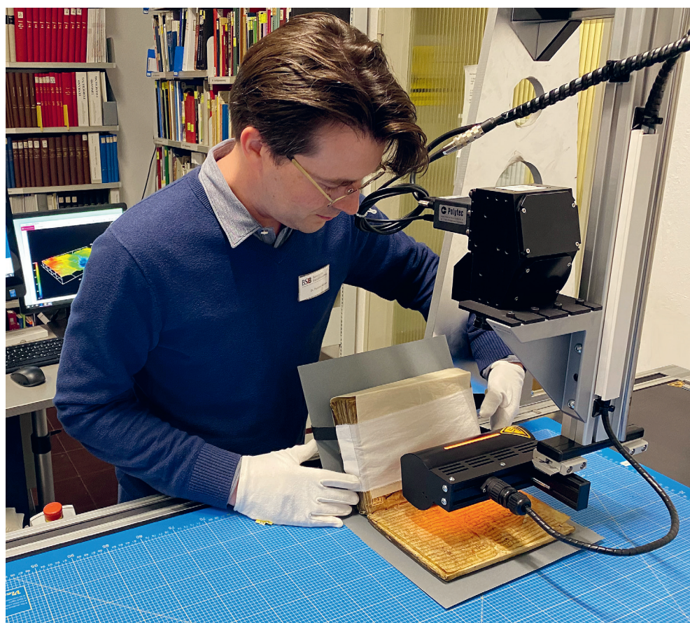
1 Hyperspectral Imaging System der Bayerischen Staatsbibliothek mit diffuser Streiflichtbeleuchtung und Portalaufbau
