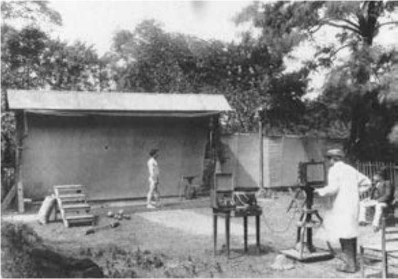
Abbildung 1: Albert Londe bedient die von ihm entwickelte Kamera mit zwölf Linsen und einer elektrischen Blende für fünf verschiedene Geschwindigkeiten, Étienne-Jules Marey sitzt rechts im Hintergrund, 1894
