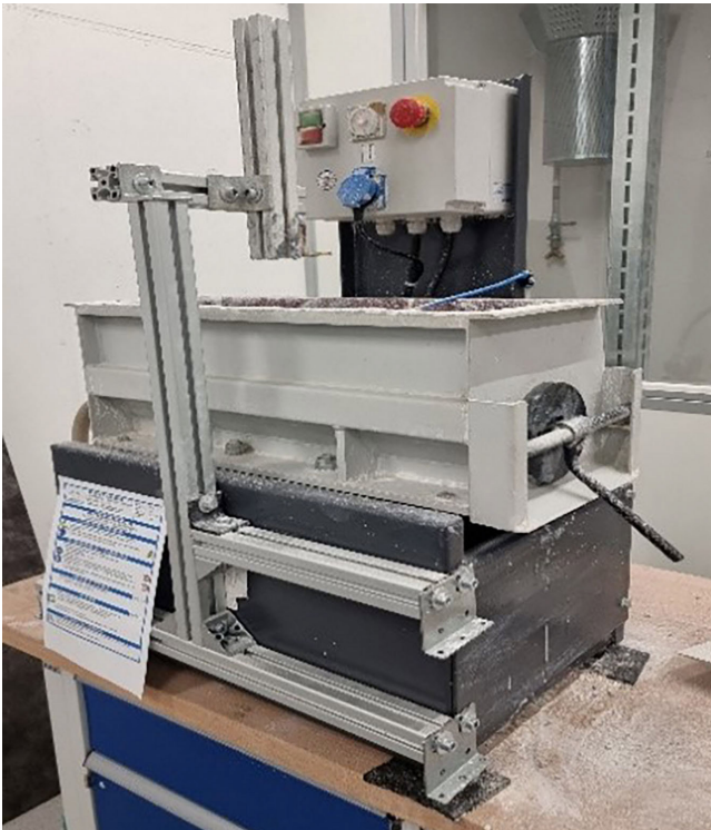
Bild 1. Verwendeter Trogvibrator Mitro Typ A für die Versuchsreihen. Grafik: Fraunhofer IPA
