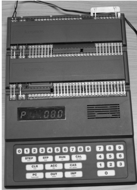
Abbildung 3.6: Kosmos CP1 mit Erweiterungsmodulen
