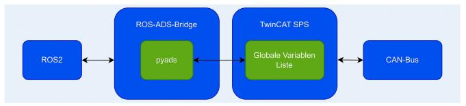
Bild 4. Die ROS-ADS-Bridge-Verbindung. Grafik: ISW
