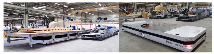
Bild 1. Cyber-physische Roboter-Vorfertigungsplattformen (links). Zu sehen ist auch das bestehende FTF (fahrerloses Transportfahrzeug) im beladenen (links) und unbeladenen Zustand (rechts). Foto: IntCDC
