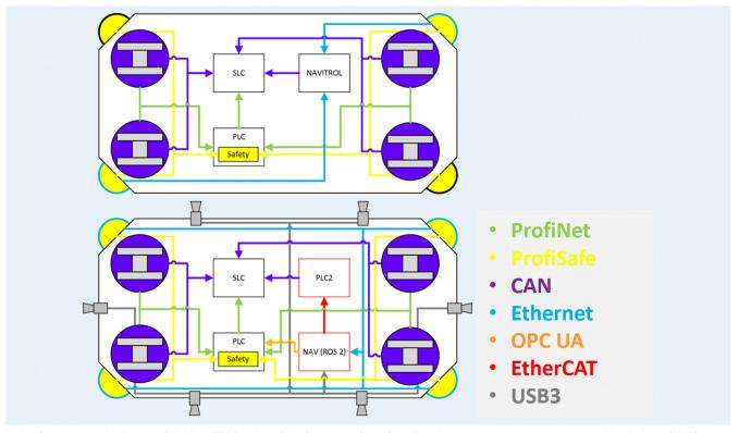
Bild 2. Steuerungsarchitektur des Stäubli "WFT PF210" vor (oben) und nach (unten) der Transformation zu einem autonomen mobilen Roboter (AMR). Grafik: ISW
