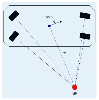
**Bild 5**. MP (Momentanpol). Darstellung der AMR-Bewegung. Alle vier Antriebseinheiten sind senkrecht zum MP ausgerichtet. Der Radius geht vom Zentrum des AMR zum MP aus und die Geschwindigkeit ist senkrecht auf den Radius. *Grafik: ISW*
