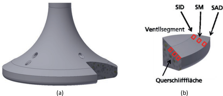
Abbildung 2.2: Probenentnahme, (a) schaftgetrennte VS mit erodierter Probe, (b) Ventilsegment mit drei markierten Untersuchungsbereichen am SID, SM und SAD
