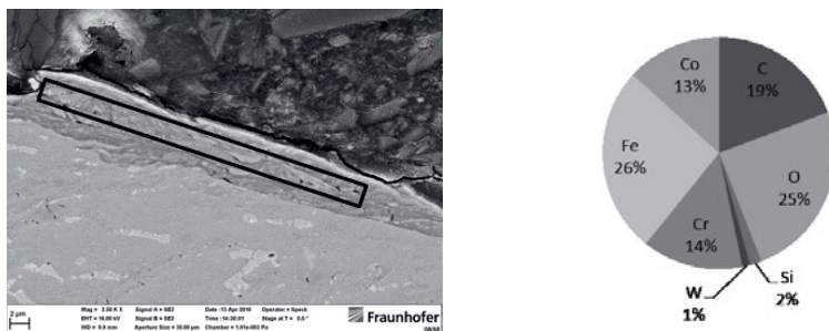
Abbildung 4.12: Detailaufnahme aus Abbildung 4.11 (d) der Triboschicht (links), zugehörige EDS-Analyse in at.-% des schwarz markierten Rechtecks links (rechts), Fe stammt vermutlich vom Gegenkörper SR aus Fe-Basis
