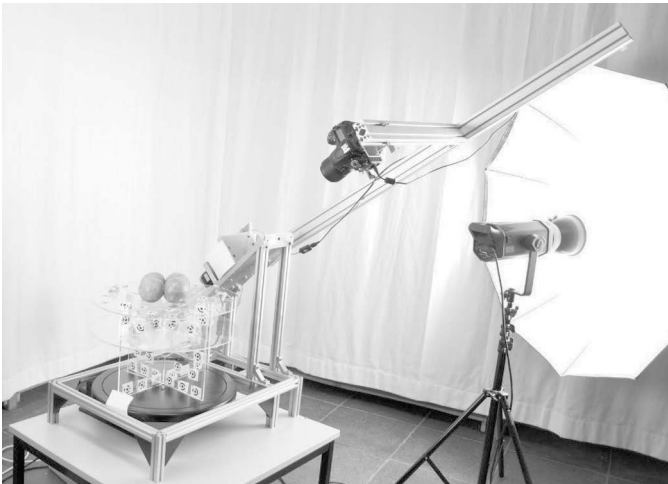
Abbildung 2: Vorrichtung aus Drehteller und Kamera-Kran-Arm zum vollautomatischen Aufnehmen beliebig vieler Fotos. Foto: Arbeitsgruppe.
