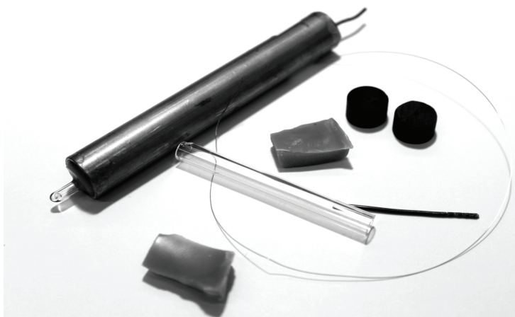
Abb. 3: Reproduktion eines Geiger-Müller-Zählrohrs der „dritten Generation“ (Nr. 16 von rund 120 verschiedenen Zählrohren) inkl. seiner Bauteile. Dieser Typ wurde sehr wahrscheinlich noch vor der ersten Publikation zum Zählrohr konstruiert. Mit herzlichem Dank an Sebastian Korff, Universität Flensburg.
