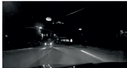
Bild 5b: HD-Stadtlicht mit aktiver Vermeidung von Blendkeulen für den entgegenkommenden Verkehr
