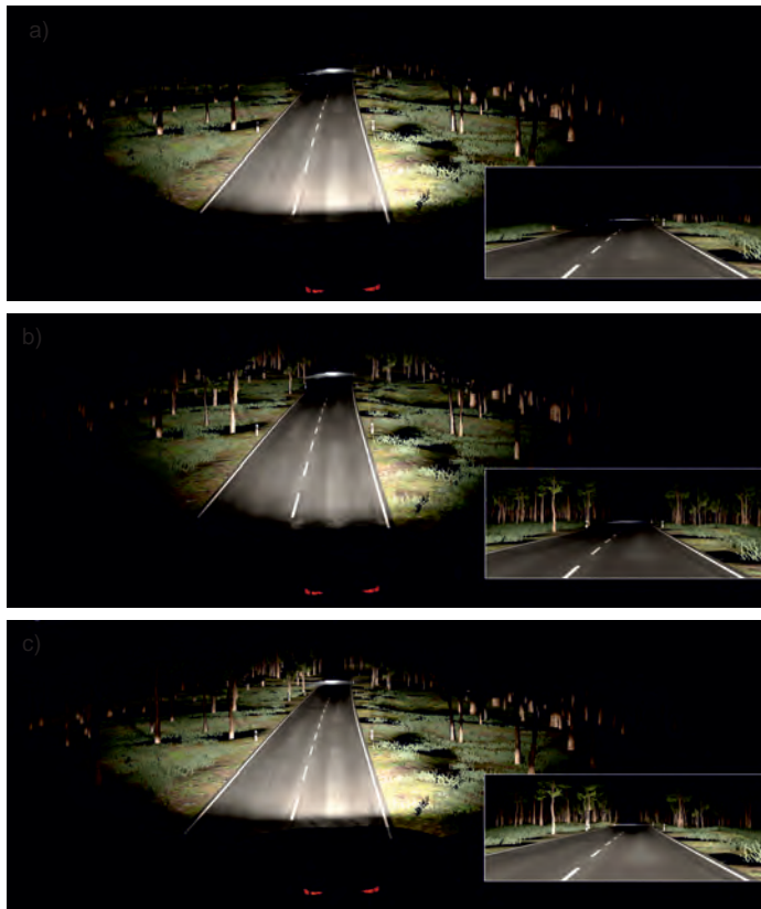
Bild 1: Nächtliche Fahrsituation mit Gegenverkehr: a) Abblendlicht, b) blendfreies Fernlicht „Einstieg“, c) blendfreies Fernlicht „high-end“
