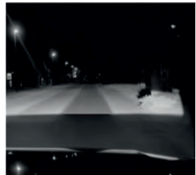
7c: HD-Stadtlicht mit seitlich erhöhter Ausleuchtung, eigene Fahrspur mit reduzierter Ausleuchtung
