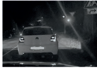
Bild 3b: HD-Stadtlicht mit aktiver Entblendung von vorausfahrenden Fahrzeugen an Ampeln und gleichzeitiger Optimierung der Beleuchtung im Seitenbereich links und rechts
