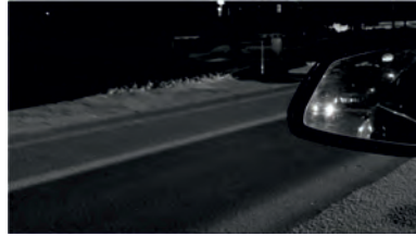
9b: HD-Stadtlicht mit Führungslinien als Kommunikationslicht für das vorausfahrende Fahrzeug
