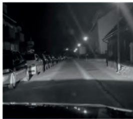
8b: HD-Stadtlcht mit Führungslinien in einer engen Straße
