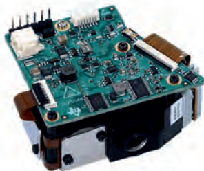
Bild 3: Beispielhafte Darstellung des in den Untersuchungen verwendeten Moduls „DLP3021LEQ1EVM“ der Firma Texas Instruments Inc.
