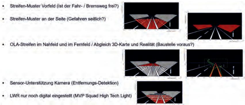
Bild 2: Use-Case-Darstellung mit mehreren Lichtstrategien zur Erkennung von Gefahren, dem freien Fahrweg, dem Abgleich des 3D-Umgebungsmodells in den Kartendaten mit der Realität und weiteren Sonderfunktionen
