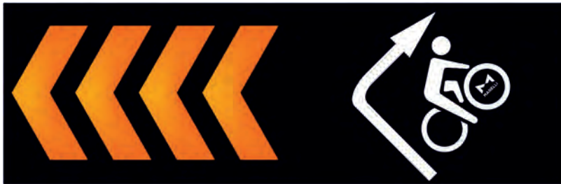
Bild 6: Darstellung der verwendeten Bodenprojektionen. Links: ECE-amber konforme Chevrons. Rechts: Abbiegewarnung an Radfahrer
