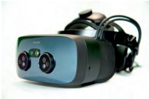
Bild 5: Mixed Reality Brille Varjio XR3 zur virtuellen Produktabsicherung lichttechnischer Systeme an der Hochschule Magdeburg-Stendal, Fachbereich IWID
