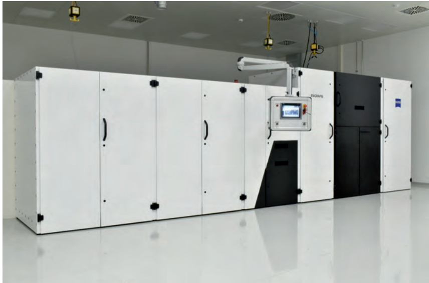
Bild 11: Erste ZEISS-Replikationsanlage zur Replikation von Volumenhologrammen
