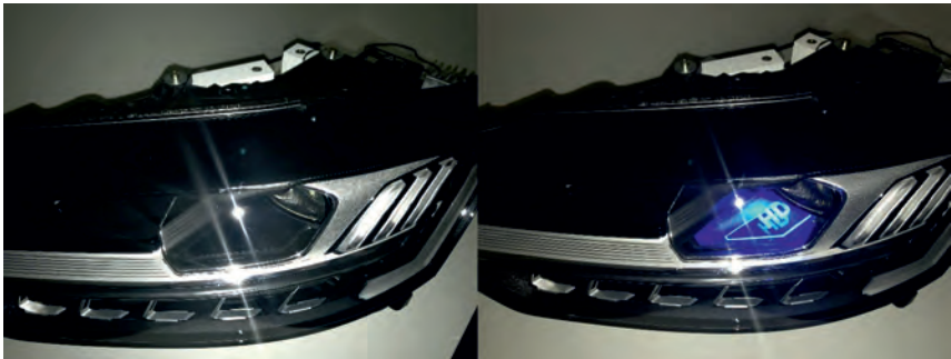
Bild 13: Scheinwerfer mit Informations-Hologramm (Welcome- / Goodbye-Funktion)
