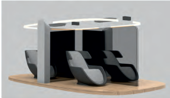
Bild 4: Details des Innenraum-Konzepts (Sitze, Trennwände, Luftfilter, Monitoring Einheiten, Lichtbänder)
