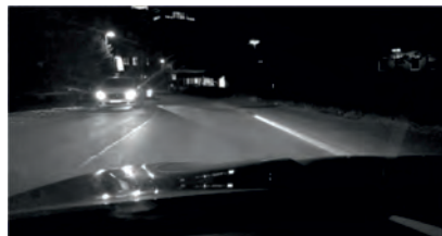
Bild 6b: HD-Stadtlicht mit aktiver Vermeidung von Blendkeulen für den entgegenkommenden Verkehr in einer Kolonnensituation
