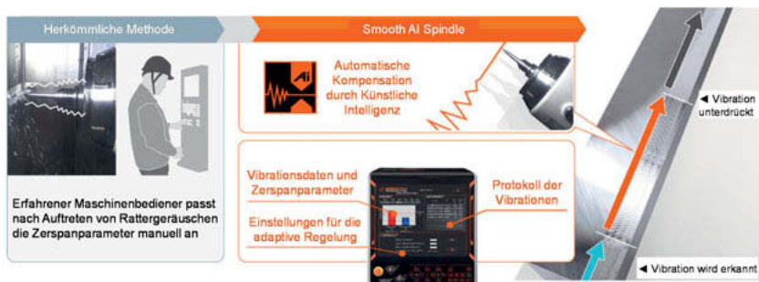
Bild 1: Künstliche Intelligenz zur Vermeidung von Ratterschwingungen
