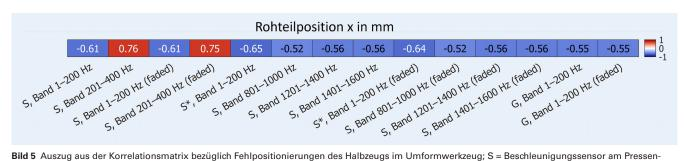
**Bild 5** Auszug aus der Korrelationsmatrix bezüglich Fehlpositionierungen des Halbzeugs im Umformwerkzeug; S = Beschleunigungssensor am Pressenstößel, G = Beschleunigungssensor am Pressengestell, Band = Energie im entsprechenden Frequenzband, \*weiterer Kanal desselben Sensors. *Grafik: IFUM*
