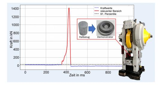
Bild 1 Exemplarischer Kraftverlauf während eines Schmiedehubs bei der Umformung eines zylindrischen Halbzeugs in die Demonstratorgeometrie mit der Exzenterpresse "Eumuco SP30d". Grafik: Institut für Umformtechnik und Umformmaschinen (IFUM)
