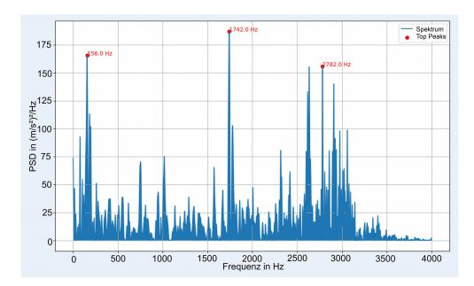
**Bild 3** Leistungsdichtespektrum eines Beschleunigungssensors nach Fade-Out-Filterung. *Grafik: IFUM*
