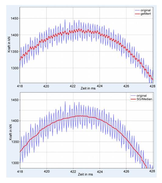
Bild 2 Kraftverlauf (blau), nach Savitzky-Golay-Filterung (oben) und nach Anwendung der Filterung SG + Median (unten). *Grafik: IFUM*
