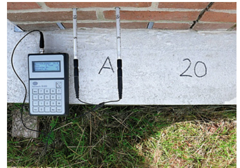
Feuchtemessung an einem Probekörper (GANN-Gerät)
