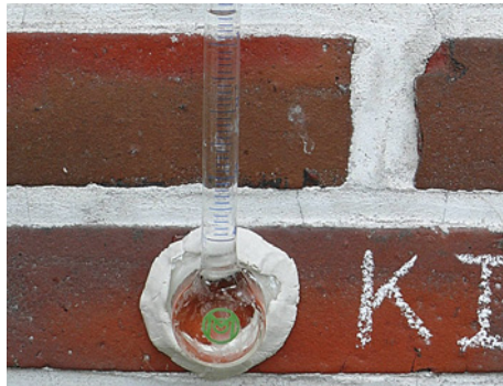
Bestimmung der Wasseraufnahme der Vor-mauerziegel (nach Karsten)
