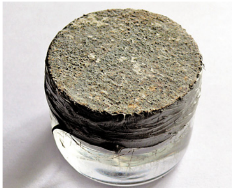
Diffusionsuntersuchungen einer Putzmörtelprobe
