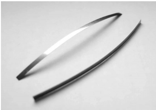
Bild 8.5 MoS 2 -beschichtete Biegestreifen für die Eigenspannungsmessungen.
