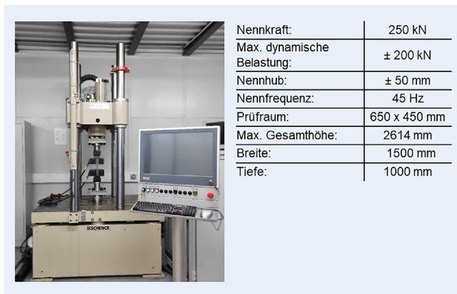
Bild 10. Hydraulische Belastungsvorrichtung mit technischen Daten. Foto: IFUM
