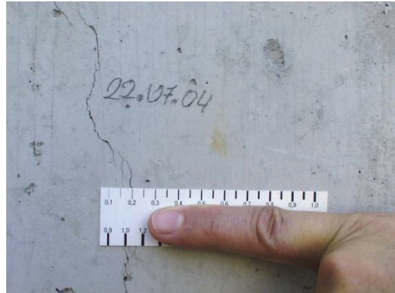
Bild 3 Riss in einer WU-Konstruktion
