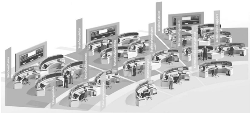
Abbildung 55: Betriebsleitstelle Untergrund der Berliner Verkehrsbetriebe mit einer Nebeneinanderlegung der zuvor profilbedingt physisch getrennten drei Teilnetze.
