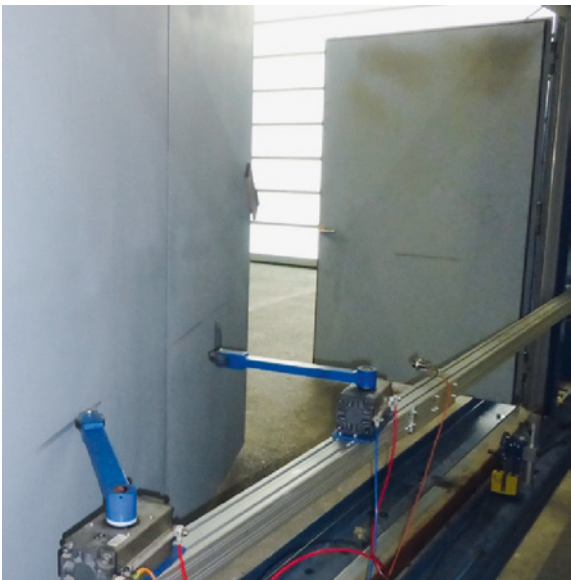
Abb. 11.24a Prüfung der Dauerfunktion (Standflügelgröße = 3,13 m) [Quelle: PFB Rosenheim]
