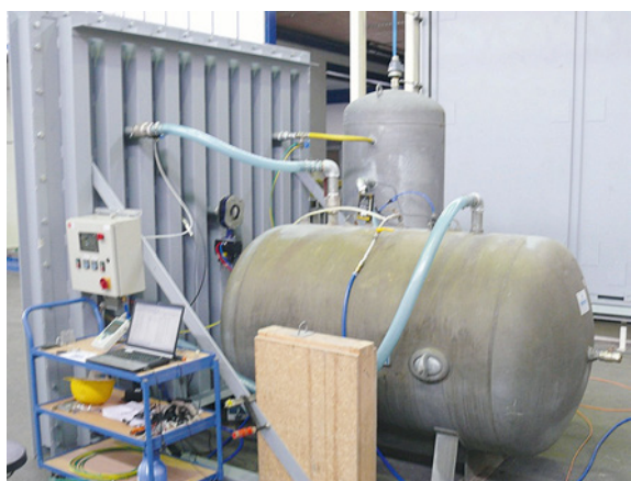
Abb. 16.7 Prüfung an einer zweiflügeligen Stahlblechtüre unter Druckwelleneinfluss [Quelle: PFB Rosenheim]
