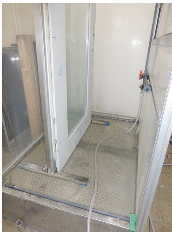
Abb. 17.2 Wasserlagerung eines spritzwasserbeständigen Türblattes für eine Stunde nach Ablauf der 96 Zyklen [Quelle: PFB Rosenheim]
