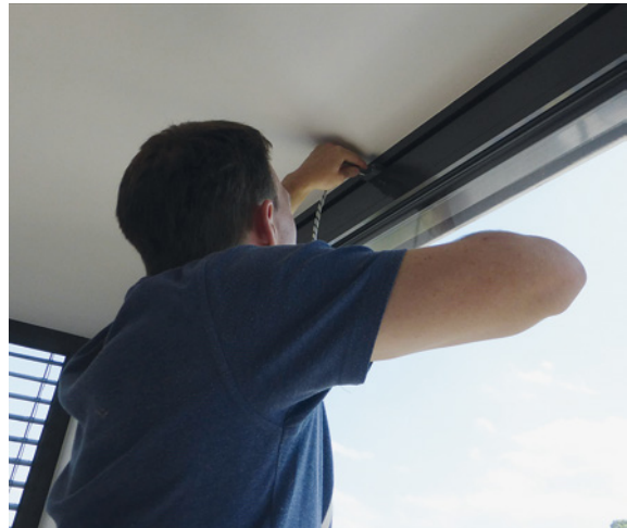
Abb. 12.1 Messung der Bauanschlussfuge mit Strömungsmesssonde an einer Fenstertür [Quelle: Pfb Rosenheim]
