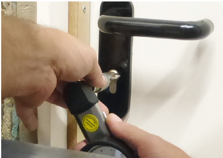
Abb. 11.23a Prüfung nach DIN EN 12046-2 [Quelle: PfB Rosenheim (Prüfung der Bedienkräfte)]
