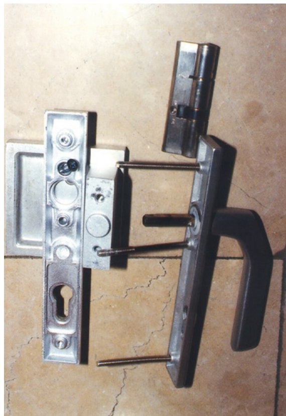
Abb. 21.1a Beispiele für Schäden an Türen: Zu große Lochbohrung für die Befestigung des Türbeschlages (⇒ lockerer Sitz), Verschiebung max. 5 mm zulässig [Quelle: PfB Rosenheim]
