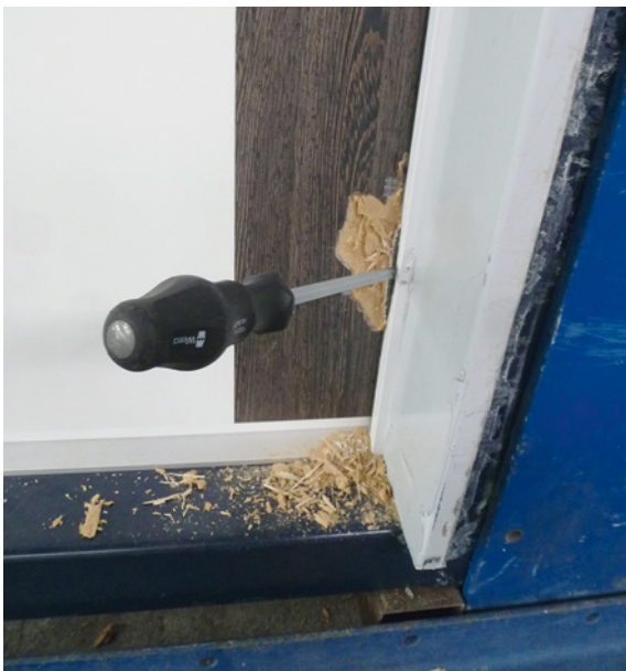
Abb. 14.24c Angriff mit dem Schraubendreher [Quelle: PfB Rosenheim]
