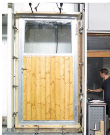
Abb. 11.25d Prüfung einer Stalltür auf Luftdurchlässigkeit und Schlagregendichtheit [Quelle: PFB Rosenheim]
