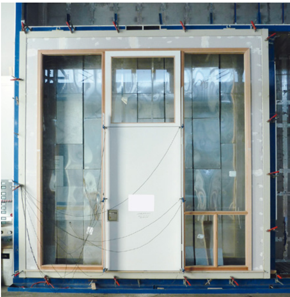
Abb. 15.17 Bauartprüfung einer Rauchschutztür nach DIN 18095-2 [Quelle: PFB Rosenheim]
