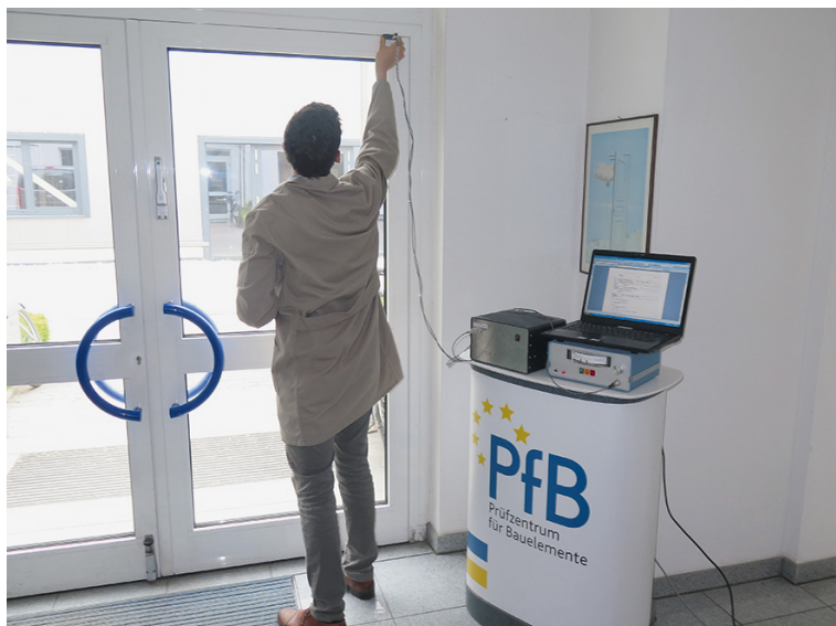
Abb. 11.25b Messung der Luftdurchlässigkeit mit Hilfe der Strömungsmesssonde und Wegstreckenzähler
