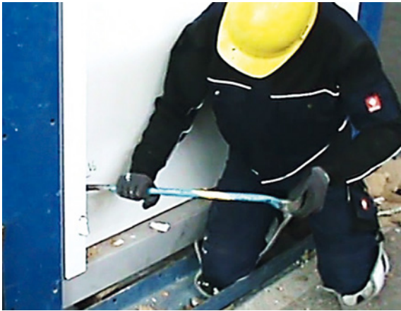
Abb. 14.24a Manueller Einbruchversuch in der Widerstandsklasse RC 3 im PfB [Quelle: PfB Rosenheim]
