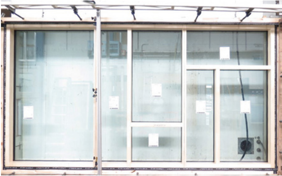
Abb. 11.28 Windlastprüfung bei festverglasten Elementen [Quelle: PFB Rosenheim]
