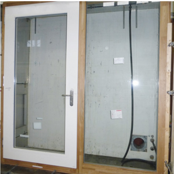
Abb. 11.26 Prüfung der Fugendurchlässigkeit und anschließender Schlagregendichtheit [Quelle: PfB Rosenheim]
