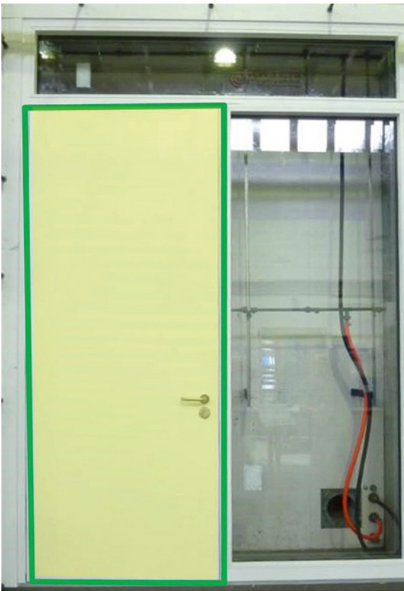
Abb. 11.25e Prüfung der Luftdurchlässigkeit einer Außentür mit Seitenteil und Oberlicht [Quelle: PfB Rosenheim]
