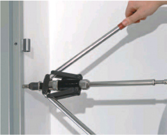
Abb. 9.19g Beispiel für Montagezange für Umrüstbänder [Quelle: Simonswerk GmbH]
