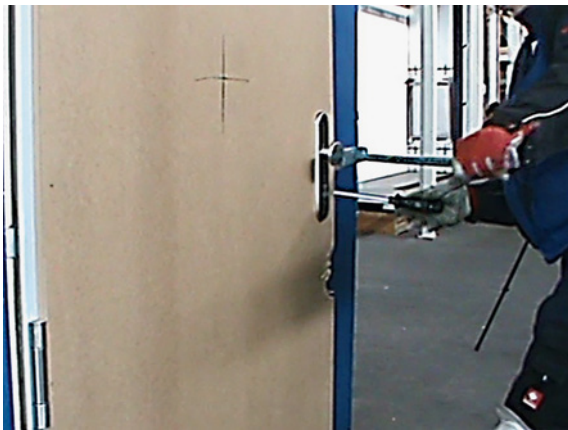
Abb. 14.24b Manueller Einbruchversuch in der Widerstandsklasse RC 3 im PfB [Quelle: PfB Rosenheim]
