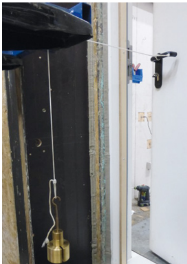
Abb. 11.23b Prüfung nach DIN EN 12046-2 [Quelle: PfB Rosenheim (Einleitung einer Bewegung = dynamische Kraft)]
