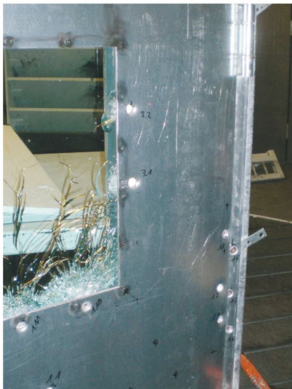
Abb. 16.2a Durchschusshemmende Türe mit Lichtausschnitt nach Prüfung [Quelle: Teckentrup (www.teckentrup.biz)]
