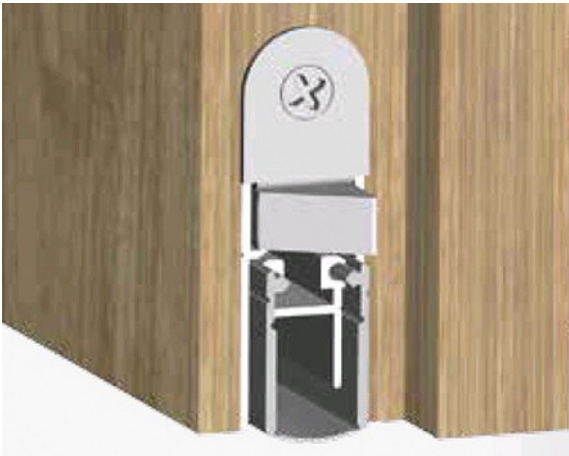
Abb. 10.13 Auslösefalle schlossseitig; SCHALL_EX® L-15/30 OS [Quelle: Athmer oHG]
