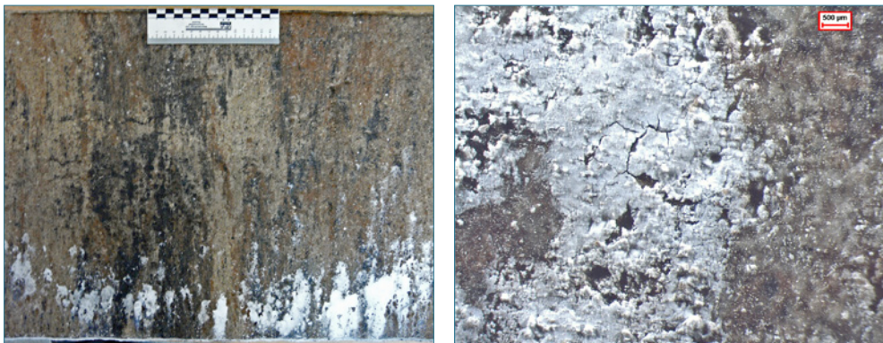
Bild 128: Calciumcarbonathaltige Ausblühungen im Bereich von Fehlstellen in der Oberflächenvergütung
