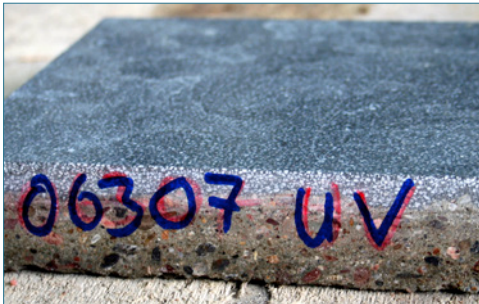
Bild 124: Eintrübung der Oberflächenvergütung bei UV-Bestrahlung
