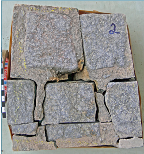
Bild 88: Geringer Verbund zwischen dem Fugenmörtel und den Natursteinen
