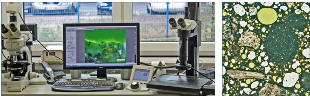
Bild 12: Bestimmung der Gehalte von Mikroluftporen an fließfähigen Betonen nach DIN EN 480-11
