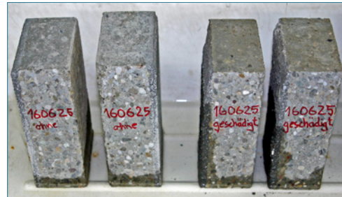
Bild 40: Saug- und Abtrocknungsverhalten von Bauwerksproben
