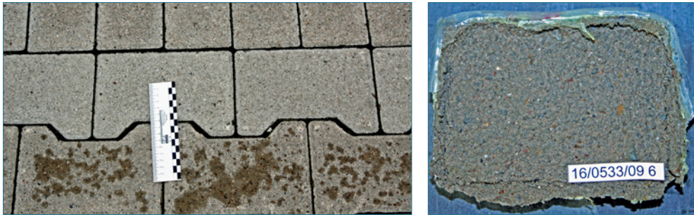
Bild 16: Frost-Tausalz-Abwitterungen von Betonpflastersteinen mit einem langsamen Abtrocknungsverhalten (links ) im Rahmen des Frost-Versuches (rechts)
