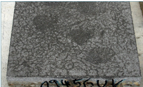
Bild 125: Schrumpfrissbildung in der Oberflächenvergütung bei UV-Be-strahlung
