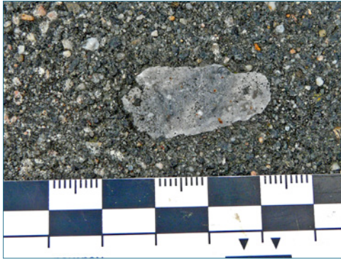
Bild 7: Gesteinskörner mit dichtem Gefüge und hohem Frost-Tausalz-Widerstand im Zentrum von Zementsteinabwitterungen
