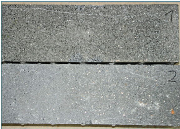
Bild 164: Farbunterschied aufgrund eines lösenden Angriffes auf die Oberflächenvergütung der Betonplatte
