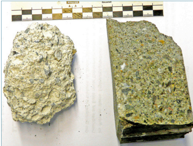
Bild 190: Farbunterschied zwischen einer mit Sulfat belasteten (links) und einer nicht belasteten Probe (rechts)
