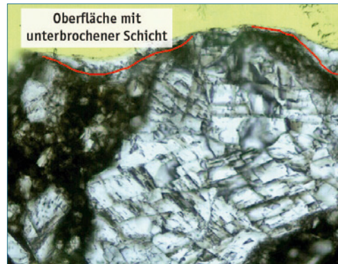
Bild 115: »Dauerhaft« Schicht bildende Oberflächenvergütung mit teilgeschlossener Oberfläche
