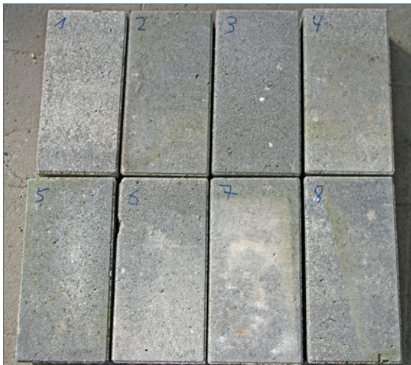
Bild 21: Löcher in der Oberfläche des Vorsatzbetons von Betonpflastersteinen
