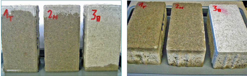
Bild 14: Abtrocknungsverhalten von Betonpflastersteinen
