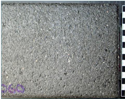
Bild 115: »Dauerhaft« Schicht bildende Oberflächenvergütung mit teilgeschlossener Oberfläche
