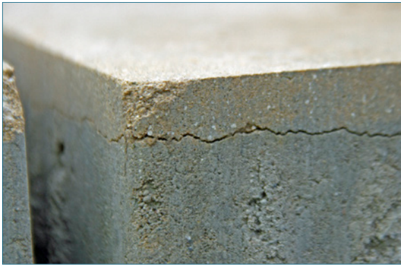
Bild 67: Trennlage zwischen dem Vorsatz- und dem Kernbeton
