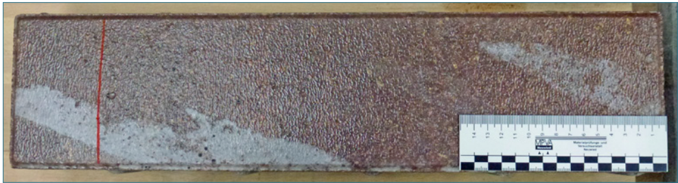
Bild 140: Milchige Verfärbung einer vergüteten Betonplatte
