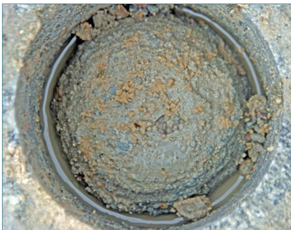
Bild 89: Nicht ausreichend wasserdurchlässiger Bettungsmörtel
