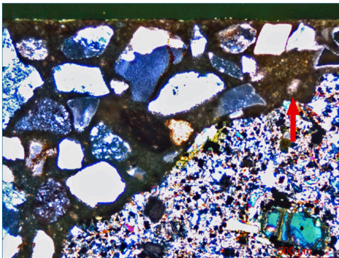
Bild 135: Detailaufnahme der Carbonatisierung der Betonoberfläche im Bereich der Fehlstelle der Oberflächenvergütung
