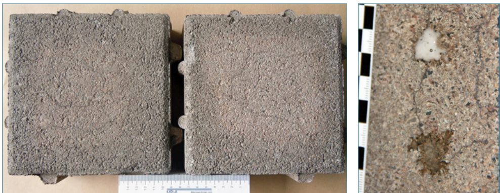
Bild 66: Wasserführende Risse in der Oberfläche eines Vorsatzbetons
