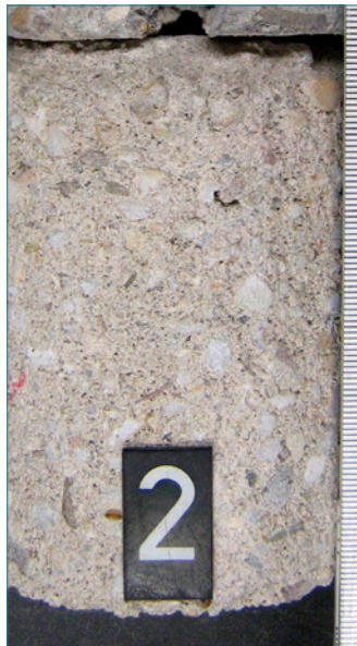
Bild 74: Vor Ort entnommene Bohrkernabschnitte
