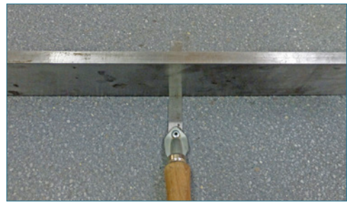
Bild 63: Laborversuch zur Bewertung der Verformung der Betonplatten bei rückwärtiger Feuchteinwirkung
