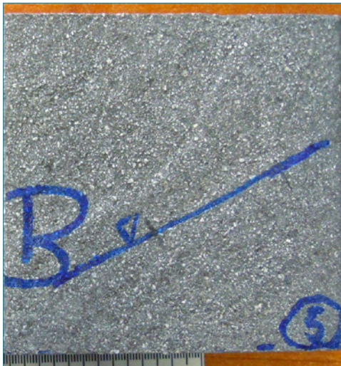
Bild 137: Über die Betonplatte verteilte auftretende, kleinflächige Aufhellungen
