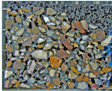
Bild 20: Zu geringe und stark schwankende Dicke des Vorsatzbetons
