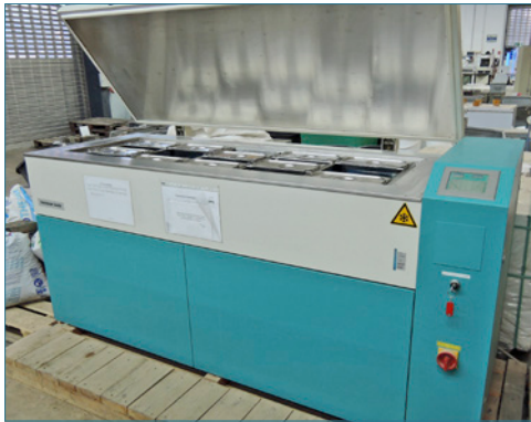
Bild 35: Frost-Tau-Wechsel-Versuch mittels des CDF-Tests
