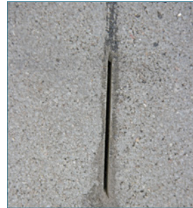
Bild 81: Fugenmörtel mit geringer Festigkeit
