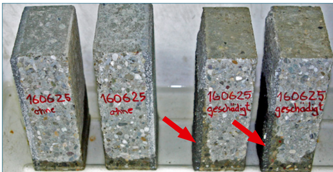
Bild 15: Saugfähigkeit des Vorsatzbetons von reklamierten Proben (rechts) und nicht reklamierten Pflastersteinen (links)
