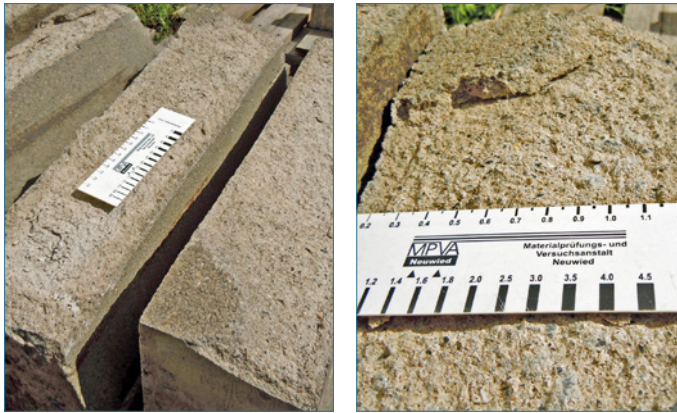
Bild 3: Durch Frost-Tau-salz-Einwirkung verursachte Zementsteinabwitterungen an Bordsteinen
