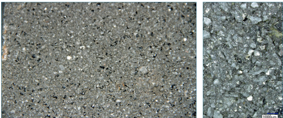
Bild 165: Farbunterschied aufgrund eines lösenden Angriffes auf die Oberflächenvergütung der Betonplatte
