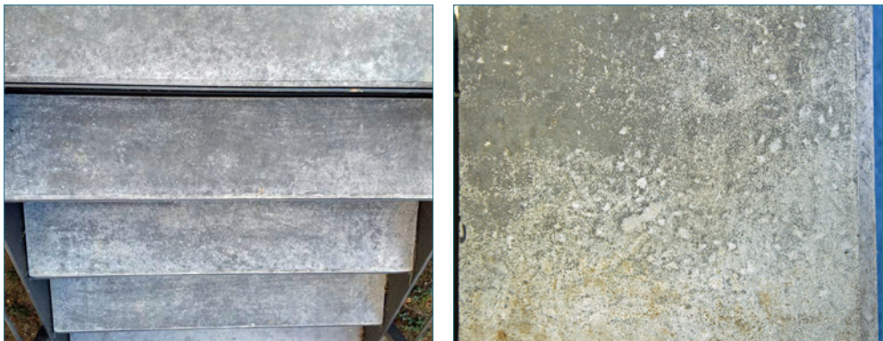
Bild 131: Farbschwankungen vergüteter Betonprodukte
