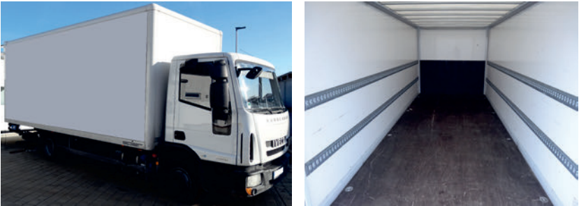
Abbildung 7.1: LKW mit Kofferaufbau zur Praxiserprobung des Laderaumanalysesystems (Außen- und Innenansicht)
