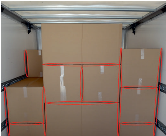
Abbildung 7.9: Spaltmaße und Staulücken zwischen den angeordneten Ladeobjekten
