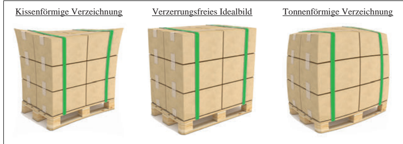
Abbildung 4.10: Vergleich der radialen Verzeichnungsarten am Beispiel einer palettierten Ladeinheit
