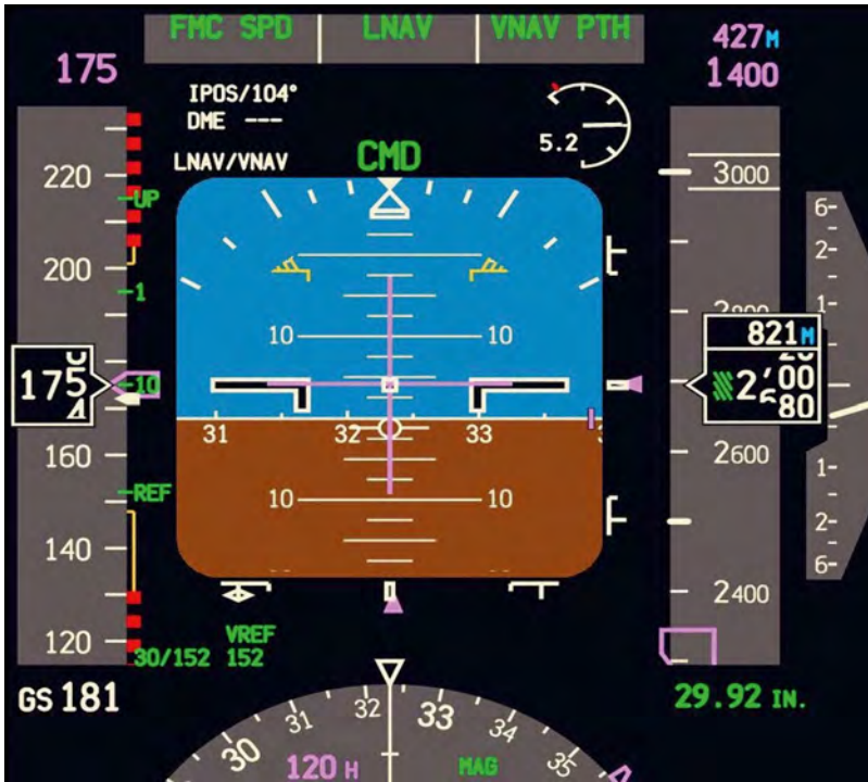
Abb. 1: Digitales Primary Flight Display (PFD) einer Boeing 737. 21
