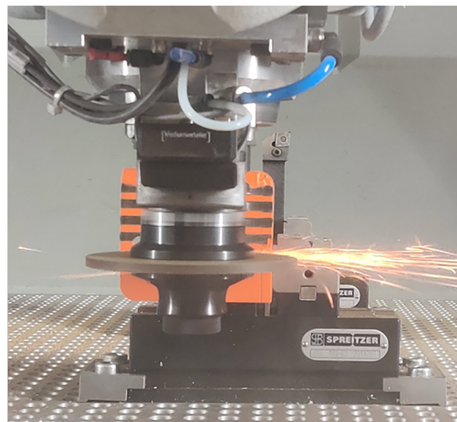
Bild 5 Schleifen lackierter Teile mit der Recycling-Schleifscheibe. Foto: [15]
