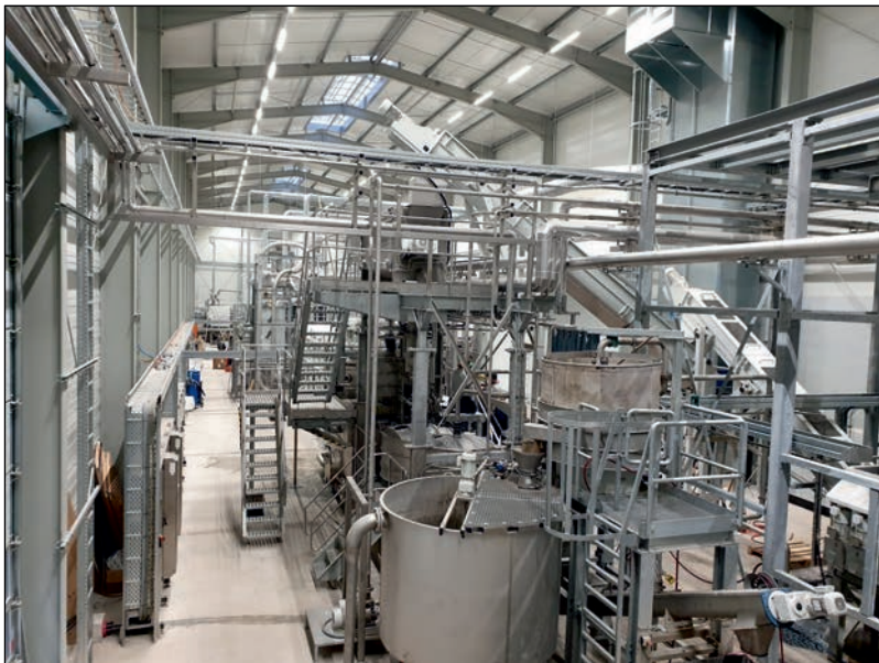
Bild 6: Waschanlage (Hersteller: Krones AG) bei der Zimmermann Recycling & Transporte GmbH, Lahnstein
