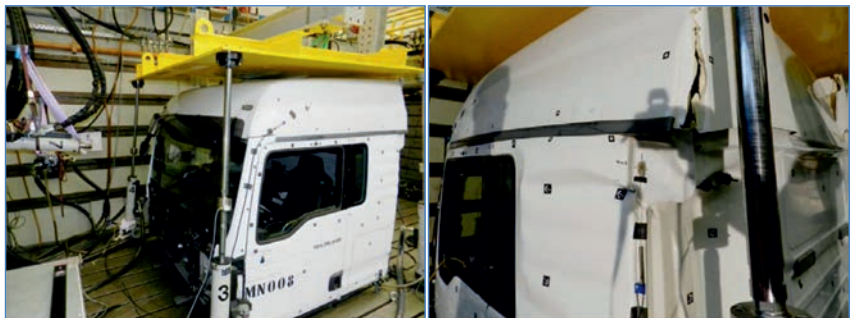
Bild 11: Erster Komponententest mit festverankerter Karosserie
