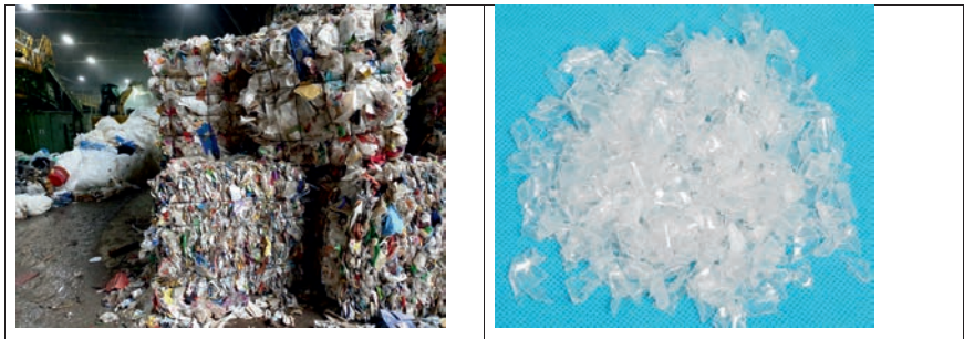
Bild 8: Ballen aus gemischtem, verschmutztem Abfall (links) wurde in einzelne Fraktionen aufgeteilt und bis zu sortenreinen Flakes (rechts) - hier am Beispiel PET - aufbereitet.
