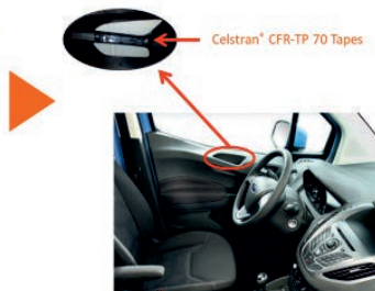
Bild 8: Celstran® CFR-TP Endlosfaser-Tape Verarbeitung als „Lokale Verstärkung“ in der Griffschale eines Türinnengriffes
