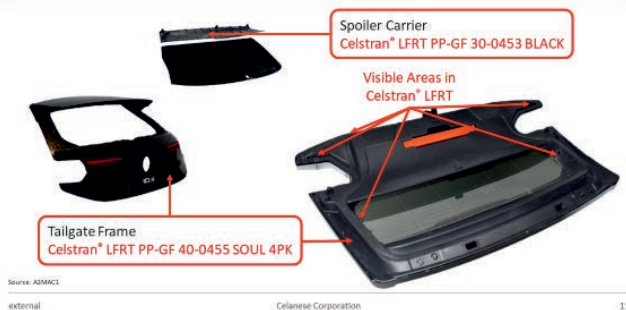
Bild 7: Materialauswahl für Träger Heckklappe und Heckspoiler
